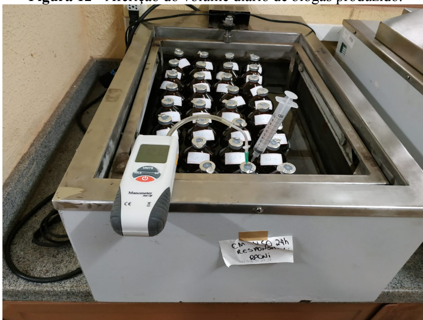
Figura 12 - Aferição do volume diário de biogás produzido.
