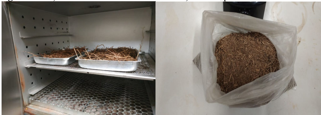
Figura 11 - a) resíduo sendo seco em estufa. b) resíduo processado e selecionado.
