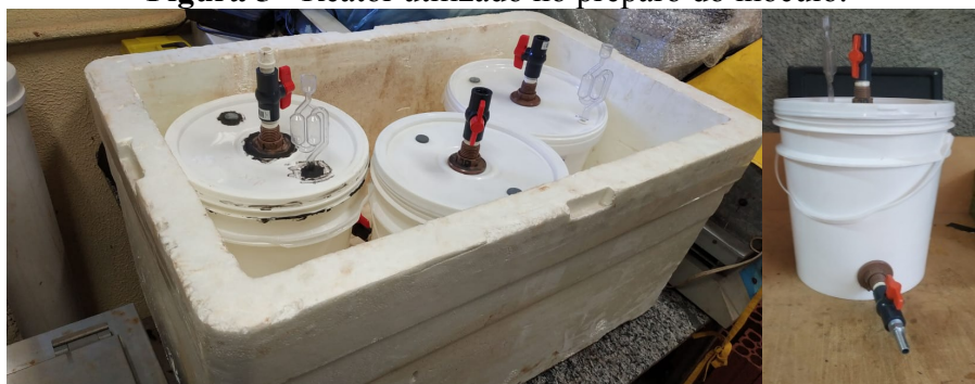
Figura 5 - Reator utilizado no preparo do inóculo.
