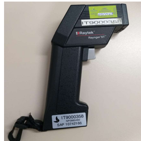
Figura 13 – Medidor de temperatura
