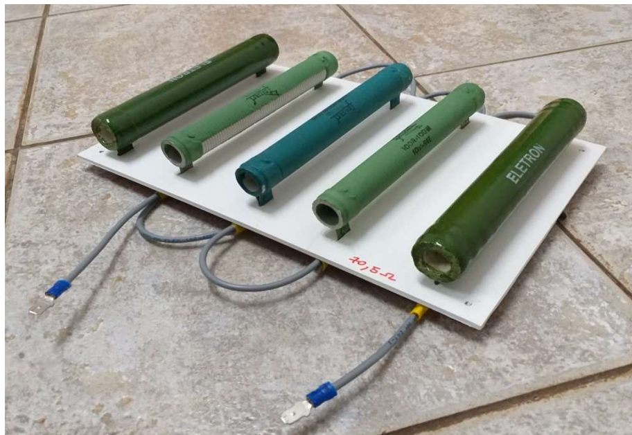
Figura 9 - Carga resistiva utilizada no experimento
