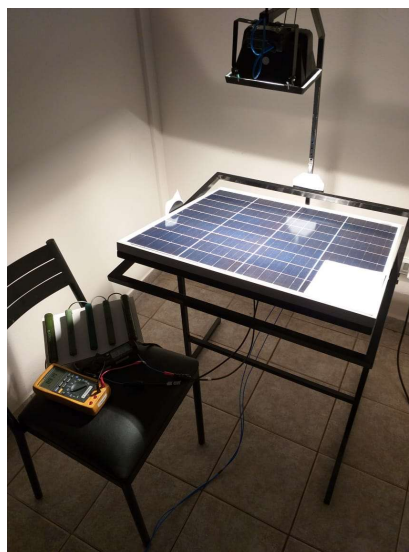
Figura 18 – Folha de papel simulando sombreamento na placa
