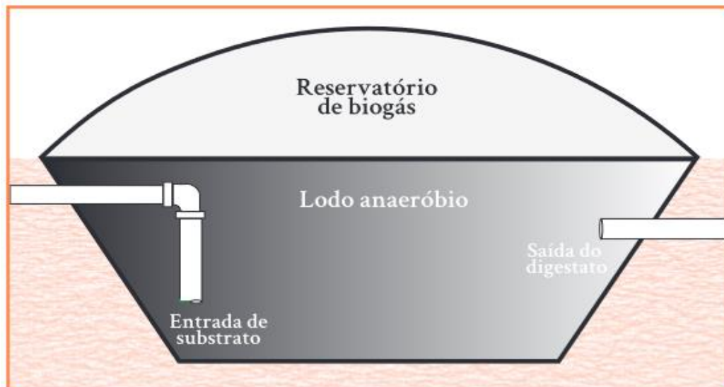
Figura 01 – Esquema representativo da visão interna do reator modelo Canadense
